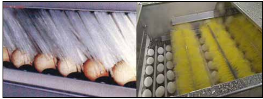
شكل (٢) ماكينات غسل البيض الكبيرة الحجم باستخدام فرش النايلون
