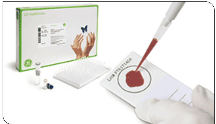
الشكل رقم ١: شكل توضيحي لمكان وضع العينة على بطاقة FTA
